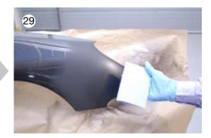
→ Après séchage, nettoyer le brouillard de peinture sur la zone avoisinante avec le tampon d'essuyage Staub Stop Water
