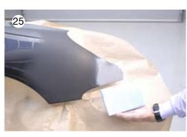
→ Nettoyage avec le tampon d'essuyage Staub Stop Water
