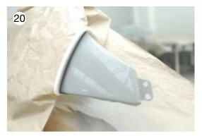
→ Appliquer l'apprêt en pulvérisant 2 à 3 couches, laisser évaporer entre les couches jusqu'à obtention d'une surface mate.
