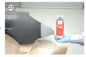
→ Si nécessaire appliquer le guide de ponçage Control spray noir
