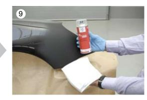
→ Nettoyage avec Nettoyant silicone et chiffon
